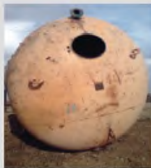
Металлическая цистерна под реактор, толщина стенок 10 мм, объем 30 м 3
