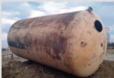
Металлическая цистерна под реактор, толщина стенок 10 мм, объем 30 м 3
