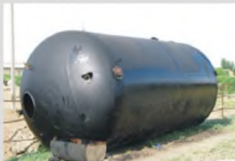
Покрытие внешней части цистерны смолой для гидроизоляции
